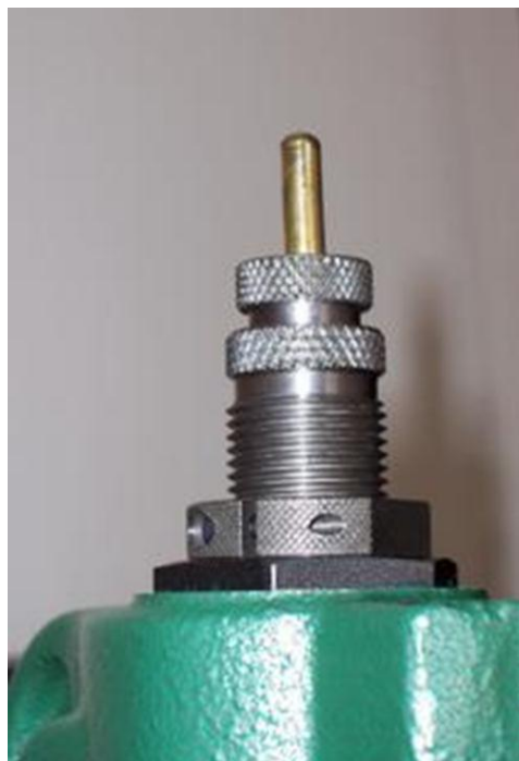
Il bossolo trasformato in mantello, così come esce dalla parte superiore della matrice
