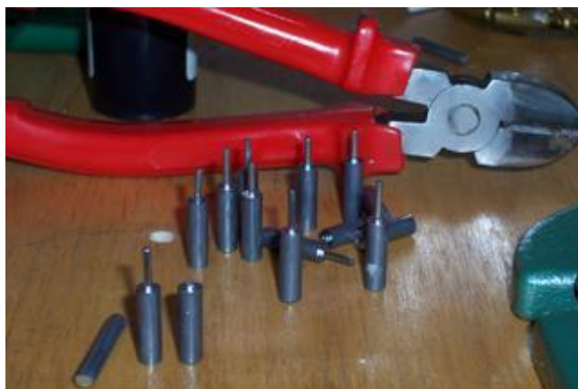
Il risultato della matrice manuale. La parte estrusa va asportata con una pinza. Usando una cesoia a faccia piatta riesco ad ottenere una tolleranza di \pm 0,25 grani.
