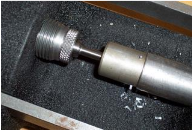
Calibratura del nucleo su pressa orizzontale dedicata, notare l'eccesso di piombo che viene estruso
