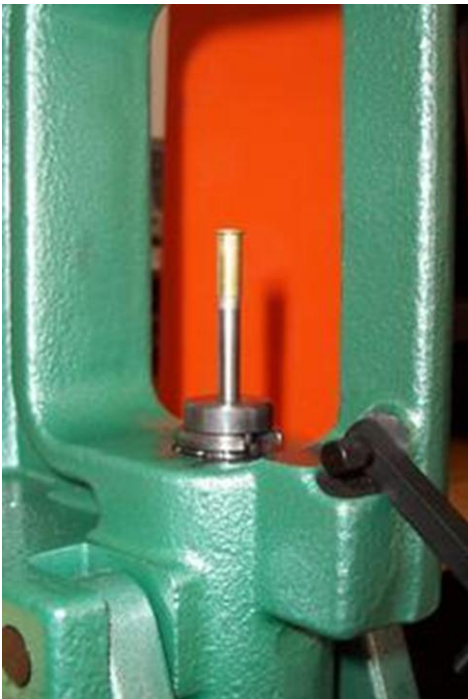
Bossolo prima di passare nella matrice che eliminerà il rim
