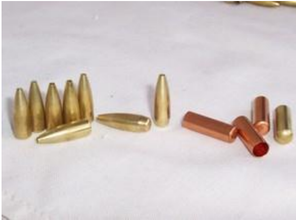
Da sinistra: palle flat base, due con boat tail, tre mantelli commerciali, un mantello casalingo
