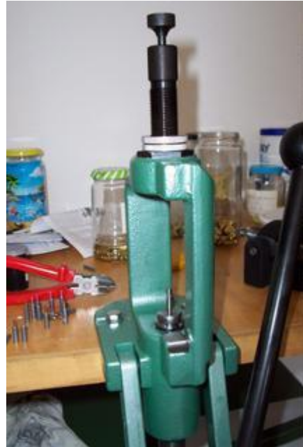
Matrice commerciale per la calibratura del nucleo, ad espulsione manuale, da usare su pressa per ricarica senza modificarla.
