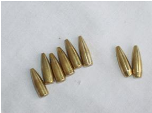
Palle flat base e boat tail ricavate da bossoli del .22 RF
