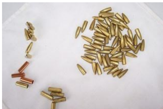
Foto di gruppo: A sinistra in alto e a destra palle finite. A sinistra in basso 3 mantelli commerciali e uno casalingo vuoto. I 5 mantelli in basso (quelli sporchi di ditate) contengono il nucleo pressato
