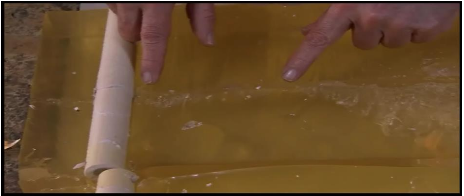
Fig. 3 Simulazione con osso sintetico che mostra la dispersione dei frammenti solo all'interno della zona afferente la cavità temporanea. La foto mostra il tramite lasciata da un proiettile FMJ, calibro 7,62. Il tratto tra le due dita delimita il narrow channel (NC), poi si apre la zona interessata dalla CT più ampia, riconoscibile dalla gelatina "maciullata". I frammenti di osso sono tutti nel NC e nella CT.
