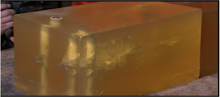
Fig. 2 Setup sperimentale per mostrare quanto descritto nel testo. Due ossa cave affogate in gelatina e riempite di midollo sintetico (anch'esso gelatina). L'osso a sinistra è stato colpito da un proiettile .308 FMJ, quello a destra da un .308 SP espansivo (da caccia) di eguale peso e velocità.
